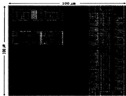
그림 15. 설계된 싱글픽셀 포토 계수기의 레이아웃 사진. Fig. 15 Layout plot of designed image sensor of single pixel photon counter type.
