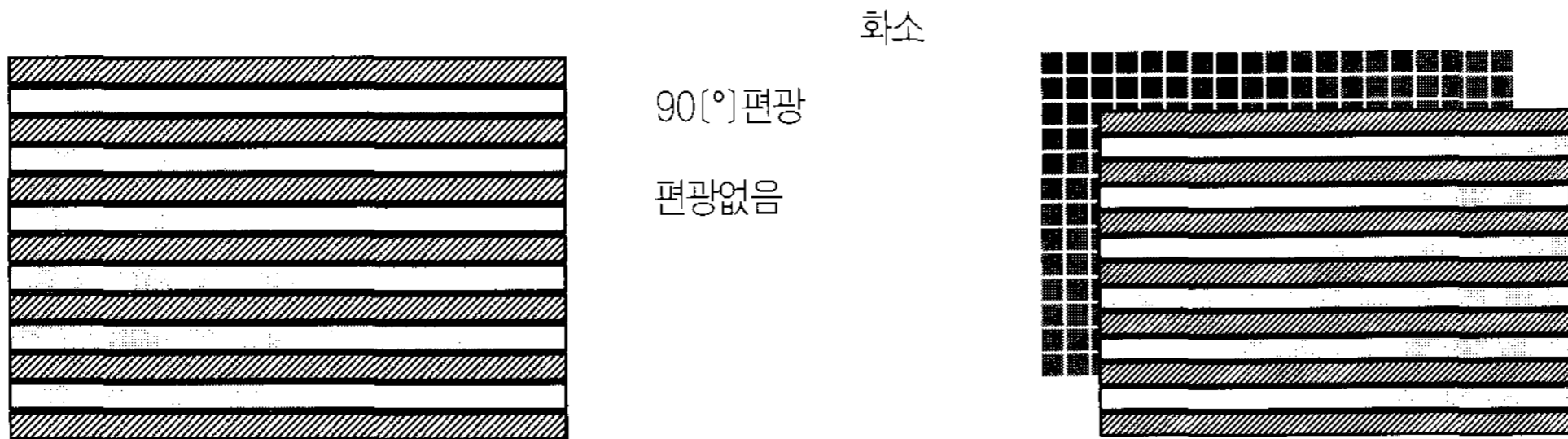
그림 2.2 마이크로 폴 (a) 패턴 (b) LCD 패널과의 접합
