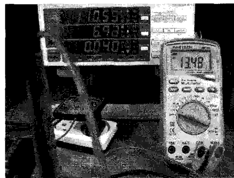
(c) 에이스전지기술(주) 방식의 변환기(왼쪽 : 50 \Omega 부하 사용, 오른쪽 : 무부하)
