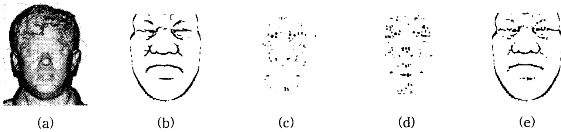
그림 7. 등고선 값 50에 의해 추출된 이진 영상들 (a) 원 영상 (b) k_1 로부터 추출된 이진 영상 (c) k_2 로부터 추출된 이진 영상 (d) K 로부터 추출된 이진 영상 (e) M 로부터 추출된 이진 영상.
