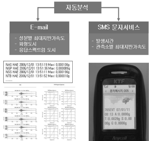
〈그림 10〉 이벤트 발생시 자동분석에 의한 경보 알림 SMS 및 E-mail 송신
