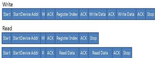
그림 4. I 2 C의 읽기/쓰기 순서 Fig. 4 Write and read sequence in I 2 C interface
