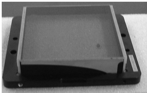
그림 3. 전압분포를 재는 액정광 감지기 사진.
