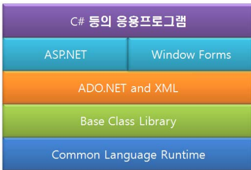
그림 1. 닷넷 프레임워크의 구성도 Fig. 1 Architecture of .NET Framework
