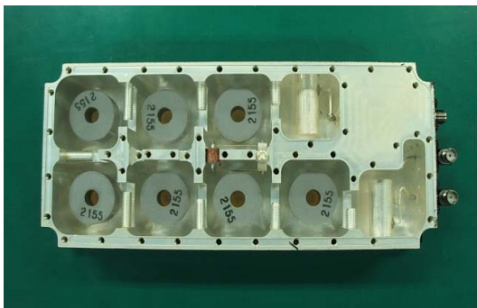
그림 8. (a)제작된 wibro용 고출력필터 Fig. 8 (a) Designed Wibro high power filter
