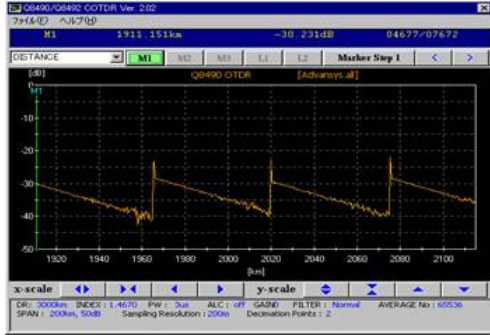
그림 4. PW 3μs 설정, C-OTDR 측정결과 Fig. 4 C-OTDR result @ PW=3μs
