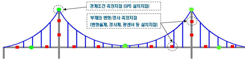
그림 3. 교량의 거동측정을 위한 GPS 센서와 타 계측기의 설치위치
