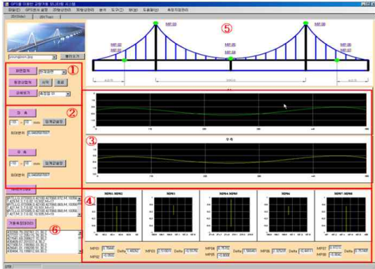
①: 현재화면출력 및 지점별 상세보기 ②: 지점별 임계치(허용오차)설정 ③: 교량의 좌우의 수직거동을 1초단위로 모니터링 ④: 수직비틀림 및 수직변위 ⑤: GPS 설치위치 및 시공도면 ⑥: 거동측정데이터
