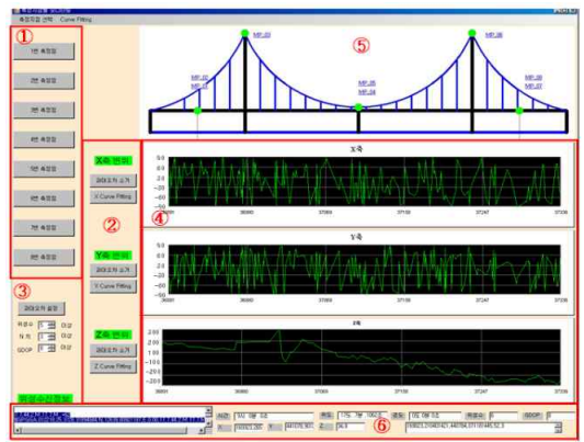
①: 지점선택 ②: 불안정 측정데이터 소거 및 추세선 생성 ③: 필터링 범위설정(관측위성수, 모호정수 상태, GDOP/HDOP) ④: 20Hz 변위그래프
