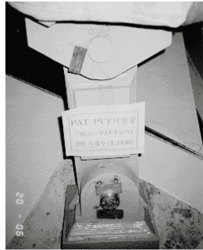
[그림 5] 로드 핀을 이용하여 과도하중 측정
