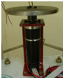
그림 1. DC 모터에 장착된 원반형 Disk
