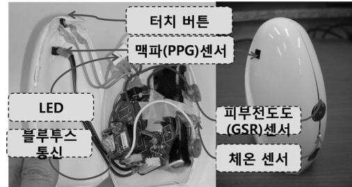
그림 4. 돌 형태의 생체 신호 측정 인터페이스 구현 결과
