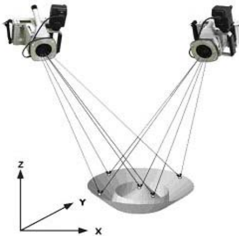
자료 : http://www.geodetic.com 웹페이지 그림 2. Multi point 삼각측량 (I)
