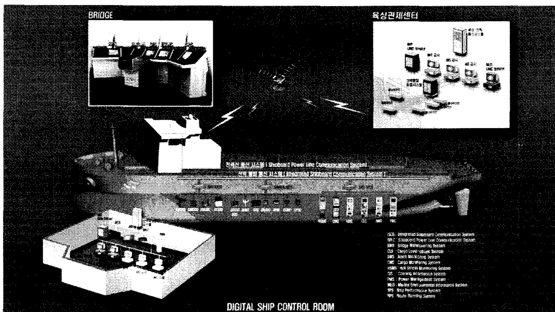
〈그림 6〉 선박 원격 실시간 감시 및 관제 시스템 운용 개념도
