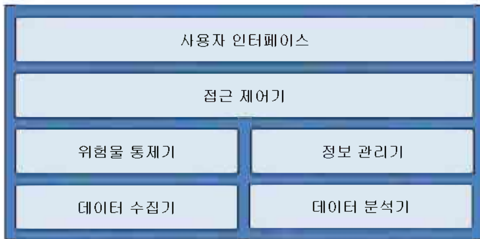
<그림 2> 위험물 모니터링 서버 소프트웨어의 구조
