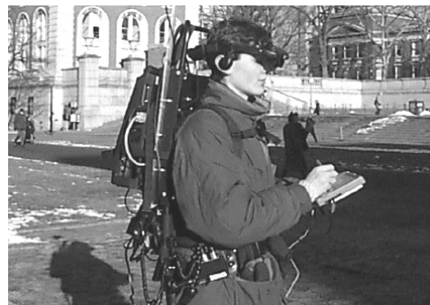
그림 1. 장비기반 증강현실 시스템 'Touring Machine'
