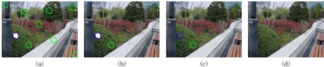
그림 5. 밴드 매칭의 과정 : (a) 목표밴드(파란색)와 후보 소스밴드들(녹색)의 비교 (b) 목표밴드와 가장 유사한 소스밴드의 위치,  $D_k$ 가 최소인 소스밴드 (c) 목표영역에 최적밴드의 내부 색상정보 채워 넣기 (d) 결과영상
