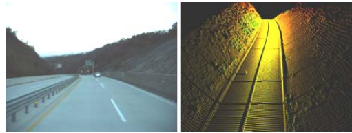
FIGURE 3. CCD 카메라와 회전식 레이저 스캐너에 의해서 취득된 데이터
