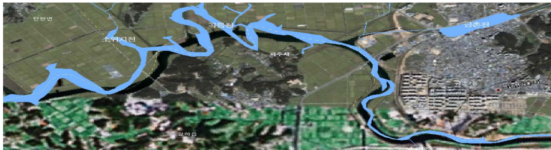
FIGURE 23. 곡릉천의 직강화 이전(2002년 수치지도)과 직강화 이후(2007년 구글어스 영상)의 모습
