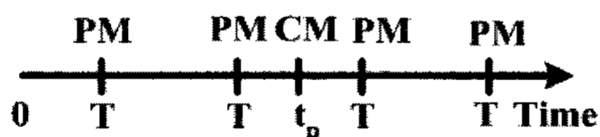
그림 2 블록 예방 유지보수 방법
