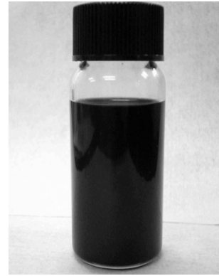
그림 5 가스중 증발법에 의한 나노 입자를 적용하여 제조한 디지털 프린팅용 Ag 용액(전자부품연구원)
