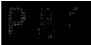
그림 18. 실제 반도체 패키지 상의 불량 마크의 예. Fig. 18. Example image of real inferior mark on IC package.
