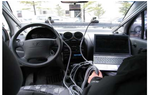
그림 2. 가변 베이스라인 스테레오 비전 시스템 및 실제 장착 모습
