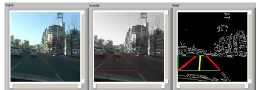
그림 15. 검출한 좌, 우측 차선 및 주행중앙선 도출 Fig. 15. Detected left, right, and center lane
