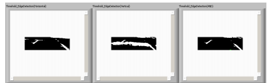
그림 12. 행과 열 기준 임계값 처리 및 AND 연산한 결과의 영상 이미지
