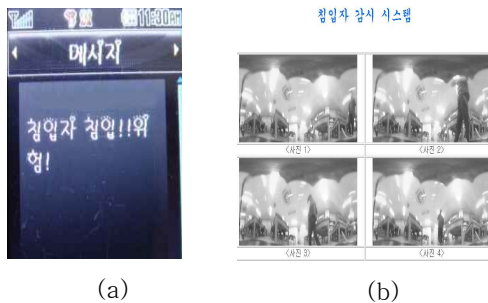
그림 15. 사용자 경고: (a) SMS를 통한 고지, (b) 웹에 현장 영상 업로드 Fig. 15. Warning to the owner: (a) Mobile phone message, (b) Scene pictures loaded upon internet web
