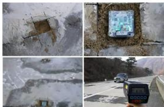
그림 4. 도로에 매설된 센서노드 및 스피드건(radar)으로 차량속도 측정
