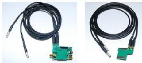
그림 5. 지온, 수온 센서모듈 및 인터페이스 보드 Fig 5. Sensor module for soil and water temperature & Interface board
