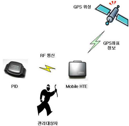
그림 2. Mobile HTE의 PID와 GPS 수신 구성도 Fig. 2. The receiving signal of mobile HTE from PID and GPS
