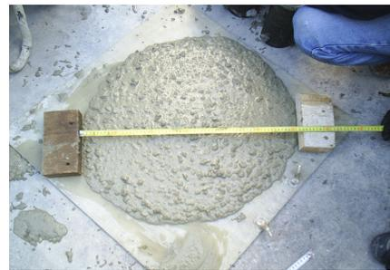
사진 8. 현장 반입 콘크리트 플로우치 확인 및 공시체 제작
