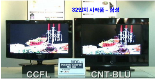
[그림 13] 32인치급 LCD에 적용된 FEL 및 CCFL과의 비교 (삼성SDI)
