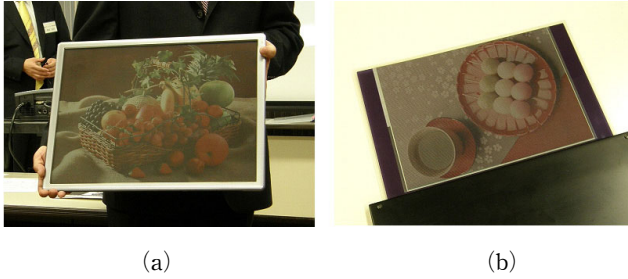
[그림 2] (a) 브릿지스톤이 개발한 세계 최대급 A3 사이즈의 풀컬러 전자종이 (b) 두께 0.29mm의 플렉시블 컬러 전자종이
