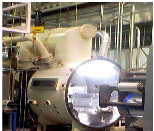
[그림 5] 진공 증착용 roll-to-roll 코팅 장비
