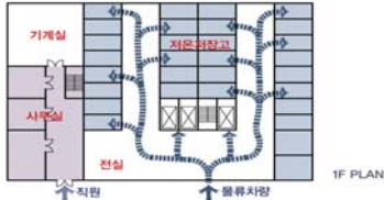
오따시장 저온창고 | 일본 -저온저장고, 사무실 -4층 규모, 화물용Elevator, 지게차이용 -1층 : 바나나 숙성실 (4~5평) 2,3,4층 : 야채저온저장실 (60~70평X6실) -연면적 약 1,100평
