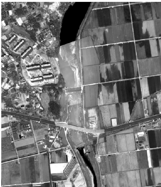
그림 8. Quickbird Pan. 영상과 UAV 영상 통합
