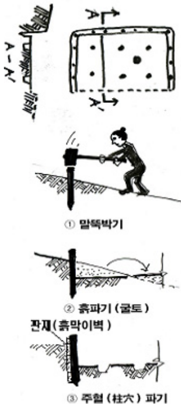
<그림 12> 움집벽체(흠막이벽)의 시공순서
