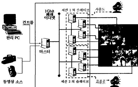
그림 1 전체 시스템 구조
