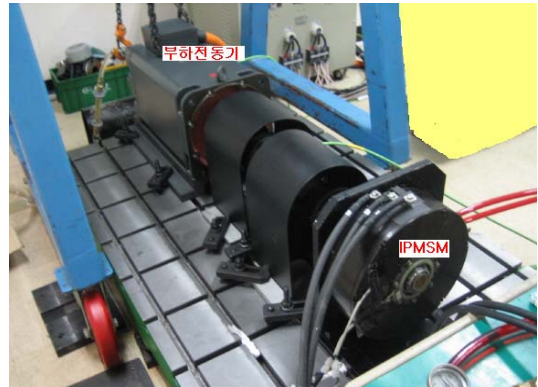
그림 16 부하시험 장치 Fig. 16 Load test bench
