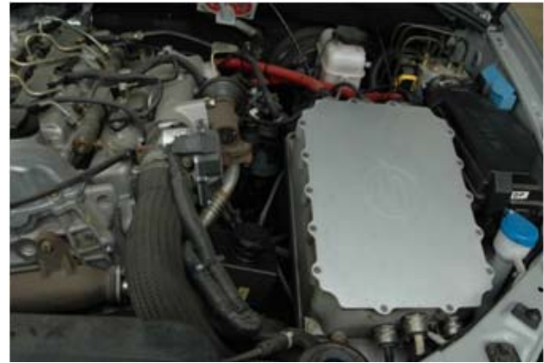
그림 23 비승압형 MCU의 차량 실장 Fig. 23 Non-boost type MCU installed in the engine room
