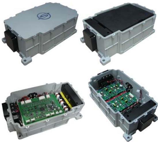
그림 15 패키지 설계 Fig. 15 Package design
