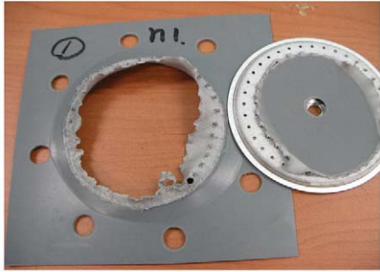
그림 7. TPO 시트와 유도가열 고정구의 부착력 시험 결과 사진
