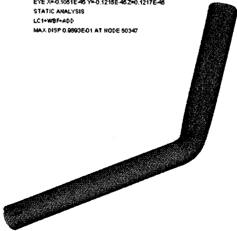
그림 14. 성토후 관로의 변형형상(Load Case 7)
