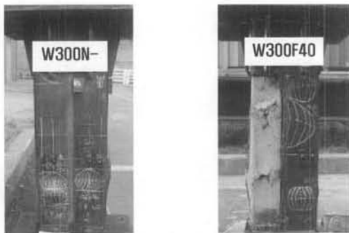
(a) 무충전 강관기둥(변위 17mm) (b) CFT 기둥(변위 33mm) 그림 10. 리브의 지점거동
