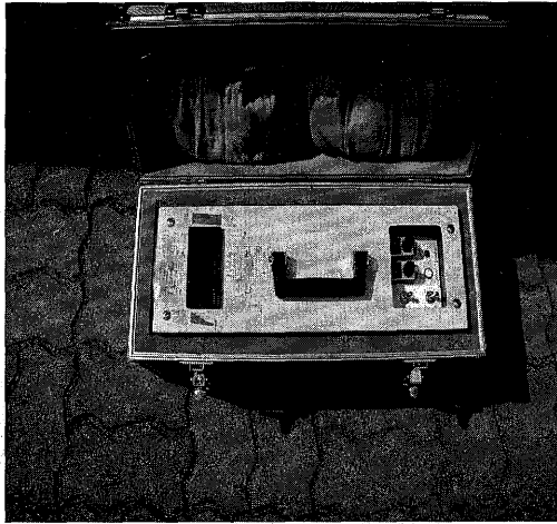
<그림 3-2> 노면표시 재귀반사성능 측정
