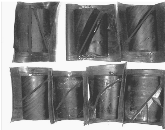
그림 6. 공시체의 파괴형상(고유 이방성 시험)
