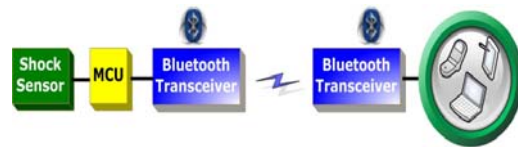
그림 7. 충격센서와 차량의 무선 단말기 간의 블루투스 통신 다이어그램
