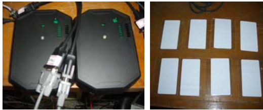
그림 5. 교통사고조사용 RGID TAG 및 READER기 Fig. 5. RGID TAG & READER for traffic accident
