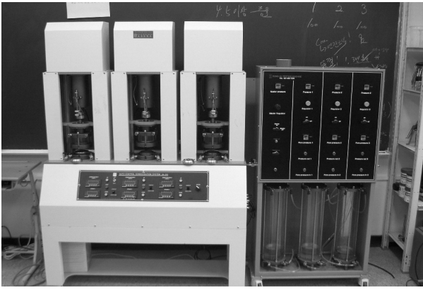
그림 11. 일정변형률재하 압밀시험기 전경 및 시료 설치광경
