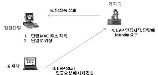
(그림 3) EAP 메시지를 이용한 서비스거부공격 유도
