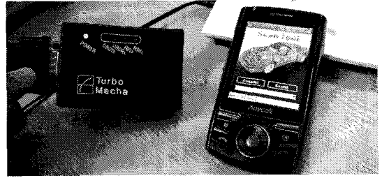
그림 1. 블루투스 통신기능이 장착된 모바일 단말기와 프로토콜 변환기를 거친 OBD-II 진단기 사이의 통신
