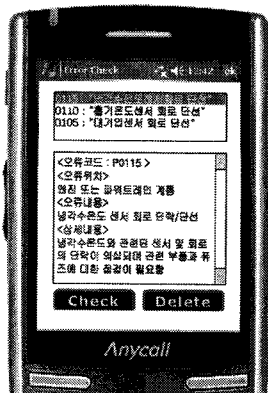
그림 10. DTC 코드값과 고장 내용을 보여주는 화면
