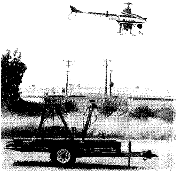
그림 1. 피치 움직임을 모사하는 착륙 플랫폼(UC Berkeley)
