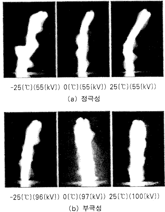
그림 7. SF 6 /N 2 혼합가스 중에서의 방전현상 Fig. 7. Discharge light images in SF 6 /N 2 mixtures
